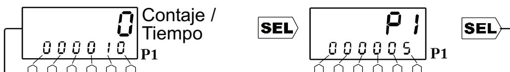
Presione SEL, luego utilice el botón Dígito para cambiar P1. El visualizador destellará. Presione SEL nuevamente para aceptar el nuevo valor. Si no se presiona SEL dentro de los 30 segundos del último cambio, P1 vuelve al valor original.
