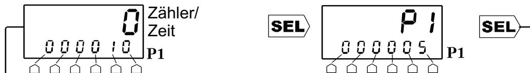
Drücken Sie SEL, und ändern Sie anschliessend P1 mit Hilfe der Zifferntasten. Daraufhin blinkt die Anzeige. Drücken Sie nochmals SEL, um den neuen Wert zu übernehmen. Wenn SEL nicht innerhalb von 30 Sekunden nach der letzten Änderung von P1 gedrückt wird, gilt wieder der ursprüngliche Wert. **Im Modus „Auf Null zurücksetzen“ wird die Änderung sofort übernommen. Im Modus „Auf P1 zurücksetzen“ wird die Änderung erst nach einem Rücksetzen übernommen.**
