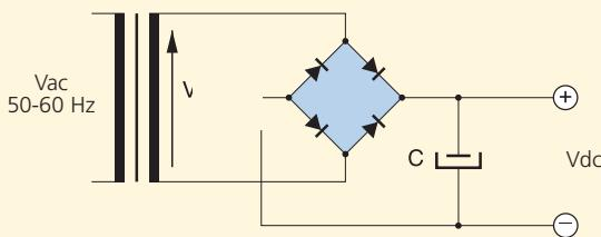
La tensione di alimentazione deve essere adeguata alle caratteristiche dei dispositivi usati. Usare sempre trasformatori con tensione di secondario Vca inferiore alla tensione continua desiderata Vcc.
